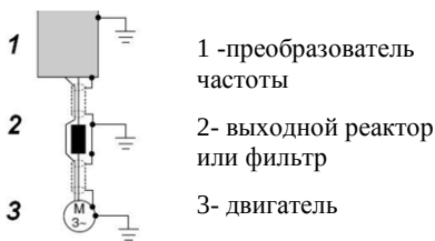
Рисунок В.2 – Схема подключения двигателя к преобразователю частоты
