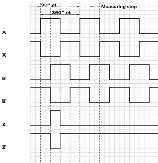
Вращение против часовой стрелки при виде на энкодер со стороны цанги
