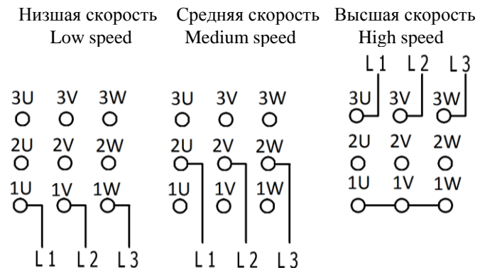
Рис.4 - Схема подключения 3-скоростного двигателя с одной отдельной обмоткой на средней скорости и одной обмоткой по схеме Даландера «Δ/YY»
