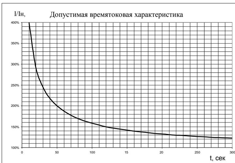
Рисунок В.4 – Допустимая времятоковая характеристика асинхронного двигателя
