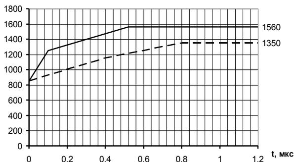
Рисунок В.1 – Зависимости допустимой амплитуды импульса напряжения на зажимах двигателя U<sub>max</sub> от времени нарастания импульса t
