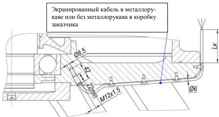
Рисунок Ж.3.1 – Вариант установки датчиков контроля температуры подшипников без коробки выводов двигателей ВАБ450
