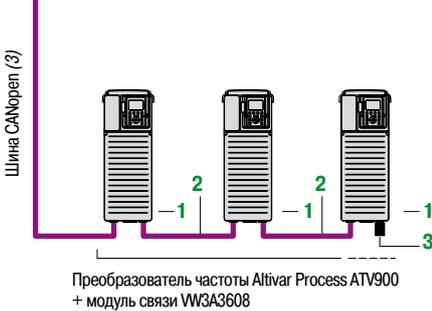
Оптимальное решение - подключение преобразователей частоты «шлейфом» на шину CANopen
