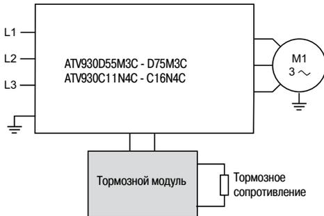
Применение тормозных модулей позволяет преобразователям частоты Altivar Process ATV900 обеспечить остановку или работу электропривода в генераторном режиме, рассеивая энергию на тормозном сопротивлении
